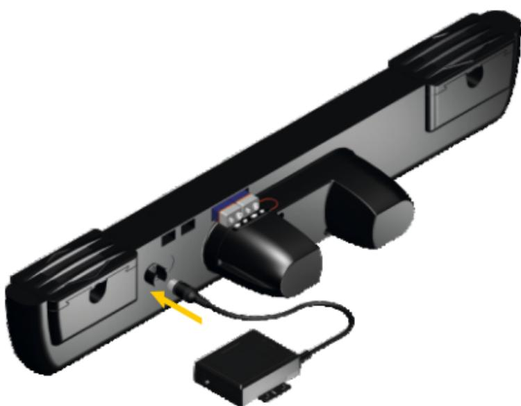
Nachdem der Funkempfänger mit dem Antriebssystem verbunden wurde und dieses wieder mit der Versorgungsspannung verbunden wurde, ist der Funkempfänger betriebsbereit.
