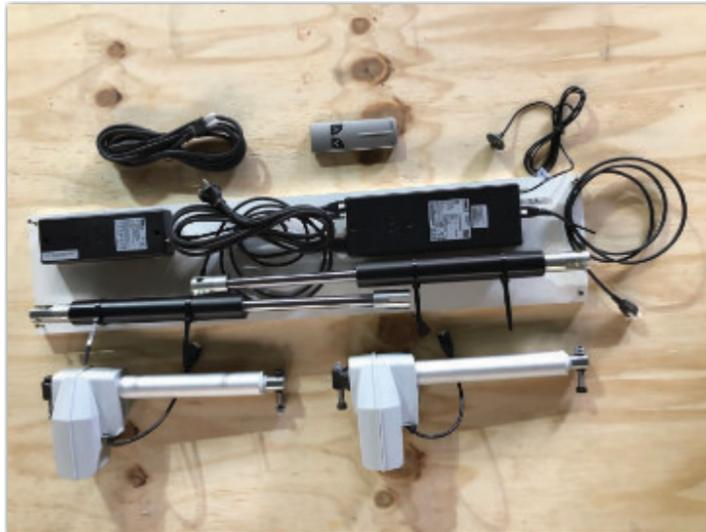
Sa fonction "HYBRIDE" composée de 2 vérins électriques équipés d'une batterie de secours assurant 20 rotations (en cas de coupure électrique), d'une télécommande radio, doublée d'un bouton d'ouverture et de fermeture, ainsi que de deux vérins gaz de secours pour ouvrir et fermer manuellement.
